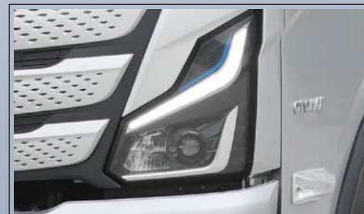
3 ustawienia i automatyczne włączanie reflektorów w celu dostosowania ich do światła zewnętrznego
